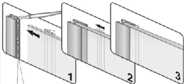
• Aplicar agua jabonosa en el hueco para poder colocar la junta con mayor facilidad.
